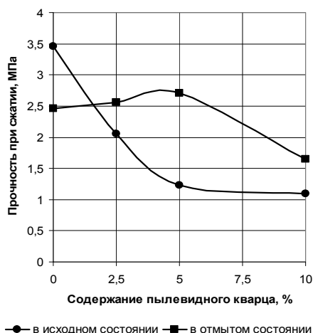
Рис. 3. Зависимость прочности смесей с Днепровским песком от количества пылевидного кварца
